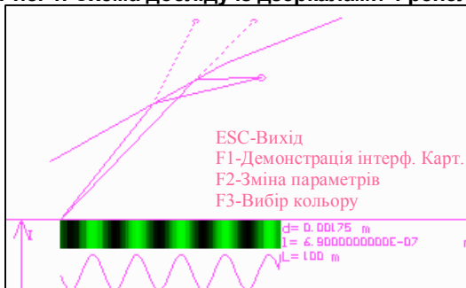
Рис. 1. Схема досліду із дзеркалами Френеля
